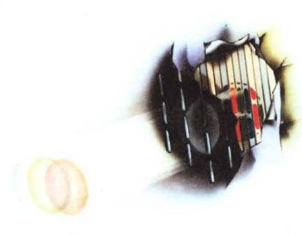
Particolare della "shadow mask" in Invar di un cinescopio con tecnologia "slotted mask"; i fasci elettronici sono rappresentati con i rispettivi colori che devono far emettere ai fosfori.
